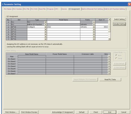
1. 打开可编程控制器参数的 “I/O Assignment (I/O 分配设置)”。
