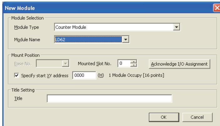
**4. 显示高速计数模块的开关设置的设置画面后，以下述方式进行设置。**
