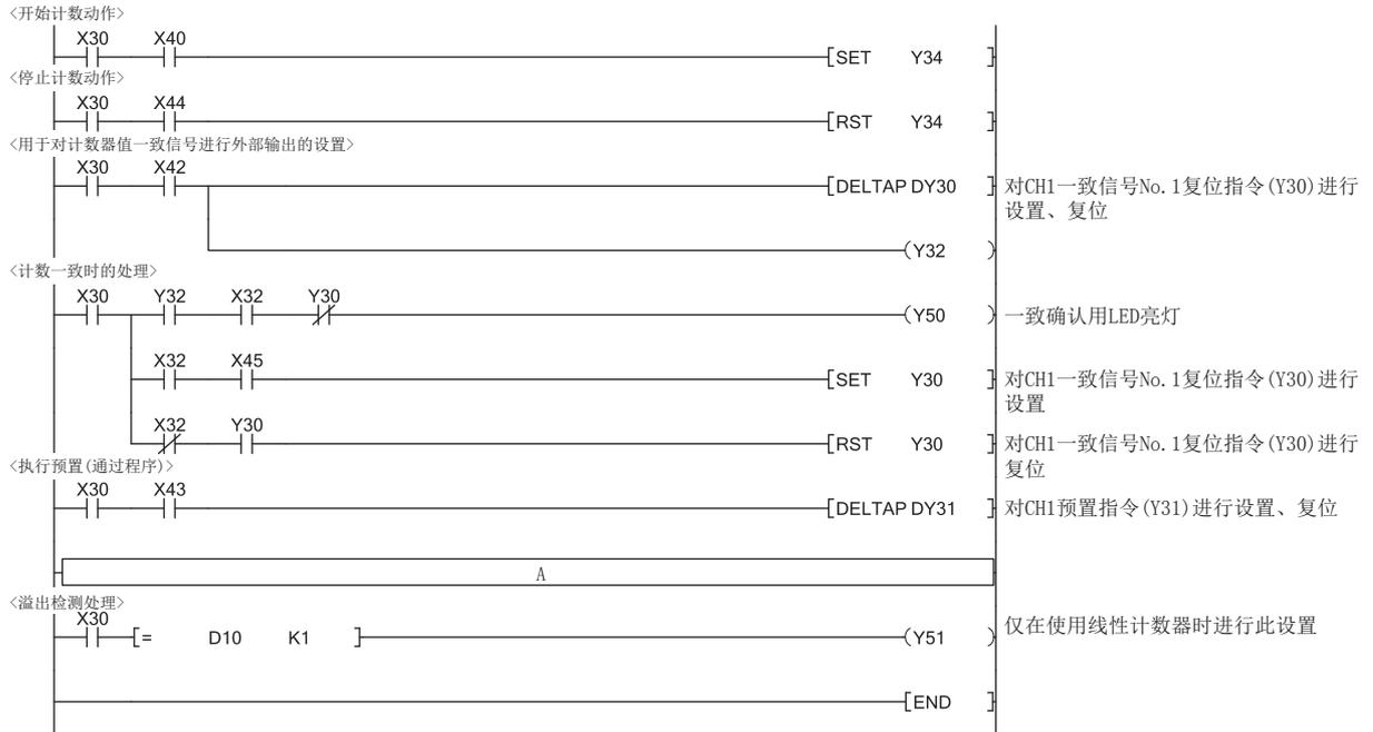
使用各功能时，应在 (d) 中记载的程序 (A 部分) 中添加下述程序。
