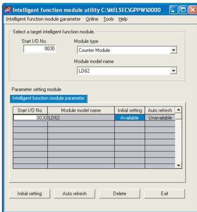
输入“Start I/O No.(起始I/O No.)”，选择“Module type(模块类型)”以及“Module model name(模块型号)”。
