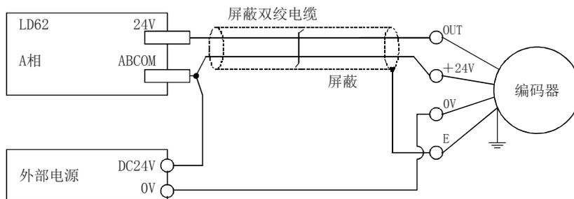
屏蔽双绞电缆中流过的电流为同一方向，因此抵消效果消失，易于受到电磁感应的干扰。
