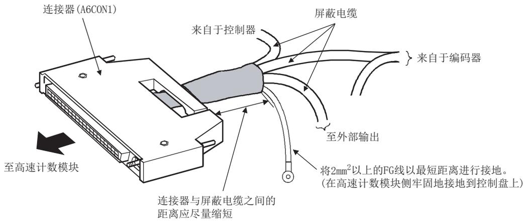
[ 屏蔽电缆的防噪声措施示例 ]
