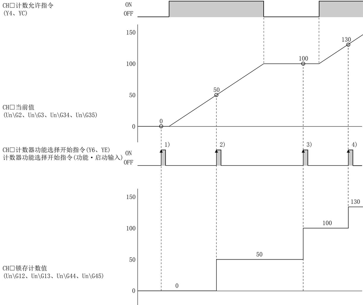
在CH□计数器功能选择开始指令 (Y6、YE) 或计数器功能选择开始指令 (功能·启动输入) 的上升沿 1) ~ 4) 时，计数器的当前值将被存储到CH□锁存计数值 (Un\G12、Un\G13、Un\G44、Un\G45) 中。
