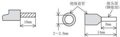
在以下图中,请确认电线插入口形状后,使用尺寸小于插入口的棒型压装端子。同时,请在插入时注意棒型压装端子的方向。违反上述要求时,可能会发生端子阻塞或端子排破损。
