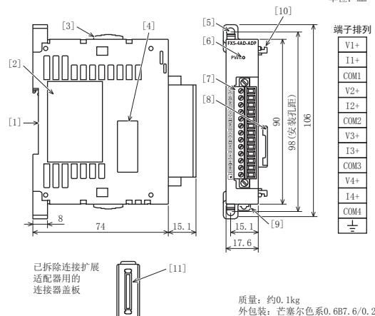
已拆除连接扩展适配器用的连接器板
