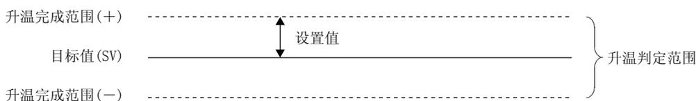
‘CH1温度测定值(PV)’（Un\G402）进入升温判定范围后，‘CH1升温判定标志’（Un\G404）将变为升温完成范围内（ON）。（对于从升温完成起至变为升温完成范围内（ON）为止的时间，应在‘CH1升温完成均热时间设置’（Un\G507）进行设置）
