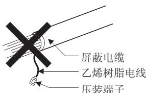
图 9.3 屏蔽层的接地处理（错误示例）
