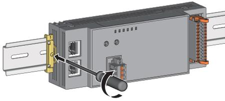
7. 朝刻在DIN導軌固定金屬配件上的箭頭反方向按壓，並以螺絲起子拴緊螺栓。
