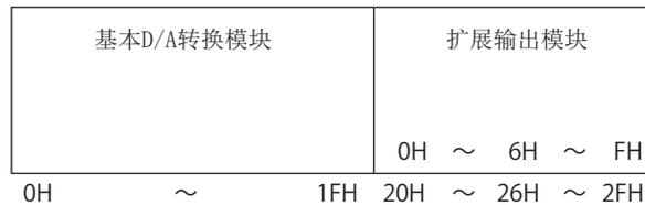
对于从扩展输出模块的起始开始计数第 6H 个的远程输出 (RY)，从基本 D/A 转换模块的起始开始计数时为第 26H 个的远程输出 (RY)。
