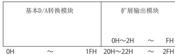
对于从扩展输出模块的起始开始计数第 2H 个的远程输出 (RY)，从基本 D/A 转换模块的起始开始计数时为第 22H 个的远程输出 (RY)。
