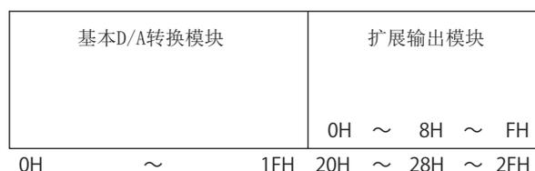
对于从扩展输入模块的起始开始第 8H 个的远程输入 (RX)，从基本 D/A 转换模块的起始开始计数时为第 28H 个的远程输入 (RX)。
